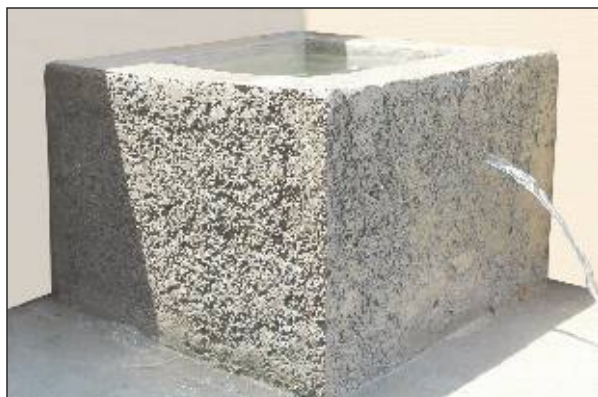
۲ - اقدام به سوراخ نمودن مخزن آب ( جهت شبیه سازی نشت منفی)
